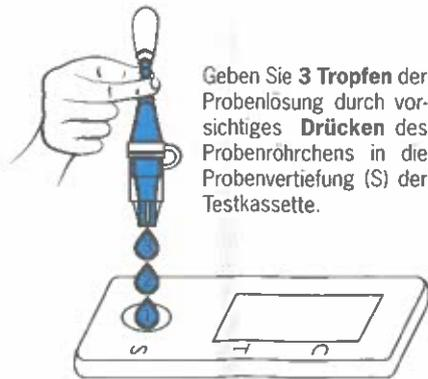
Geben Sie **3 Tropfen** der Probenlösung durch vorsichtiges **Drücken** des Probenröhrchens in die Probenvertiefung (S) der Testkassette.
